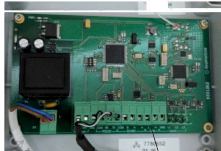
Клеммы для подключения входных сигналов
